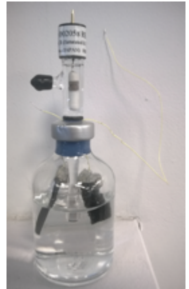
cellule électrochimique à 3 électrodes inoculée avec de l'eau du lac Pavin à la profondeur du pic de
